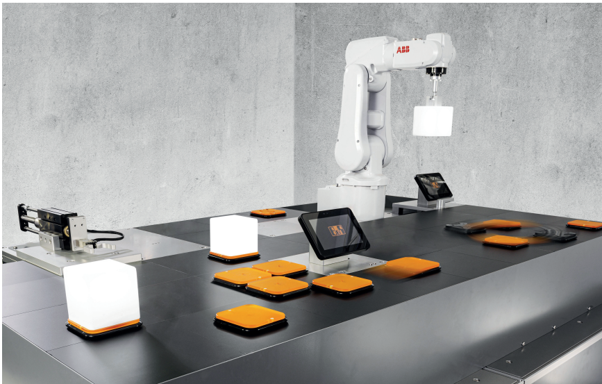
Für die Produktion in kleinen Losgrößen und mit ständig wechselnden Produktdesigns geeignet: Acopos 6D © B&R
